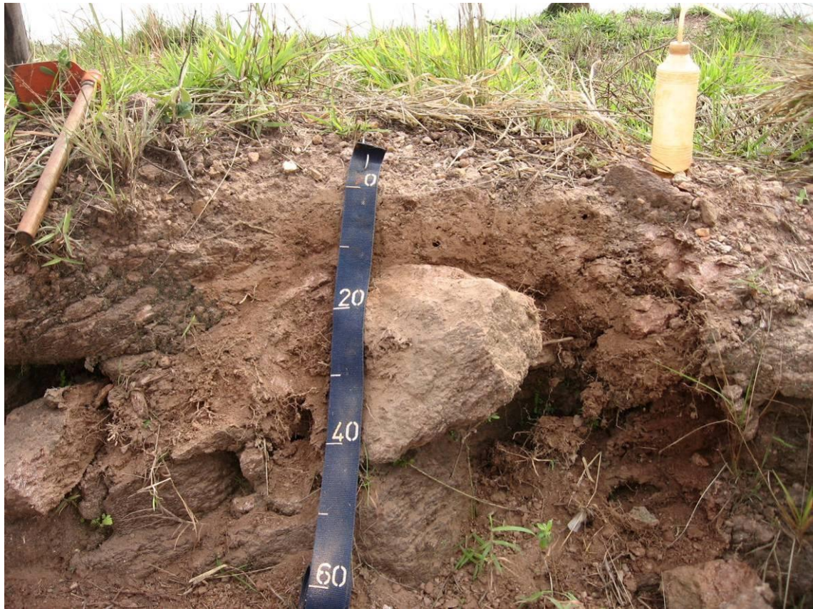
Figura 28. Perfil de Neossolo Litólico.
